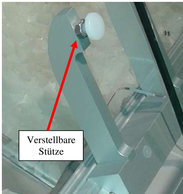
1. Höheneinstellung der Frontscheiben.
